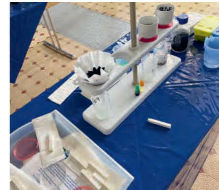
Bei diesem Versuchsaufbau lernen die Kinder, wie das Wasser durch Filtern gereinigt wird.
